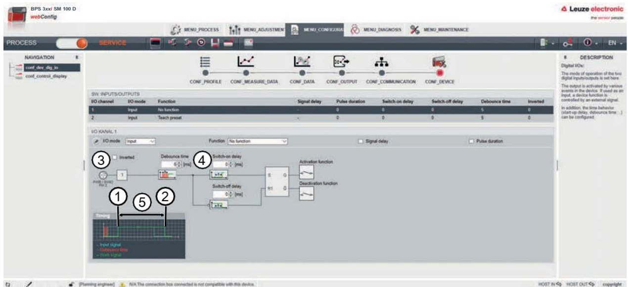
Bild 10.5: Einschaltverzögerung &gt;0 und Einschaltdauer &gt;0
